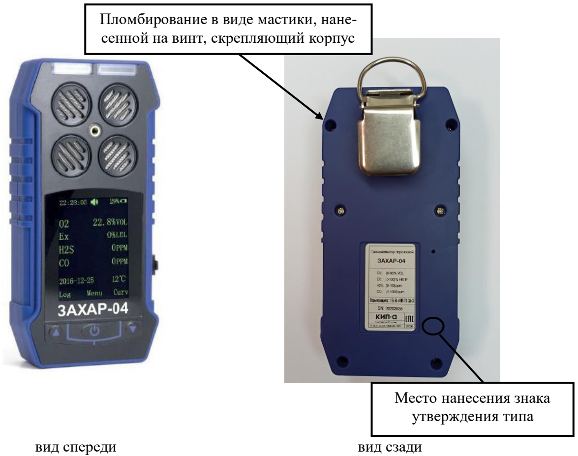
Рисунок 1 – Общий вид газоанализаторов переносных ЗАХАР-04 и место пломбирования корпуса от несанкционированного доступа
