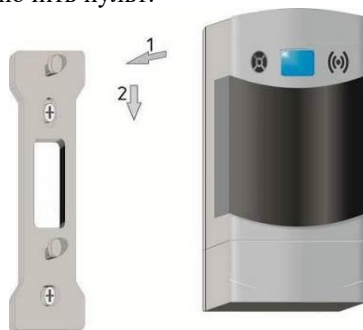
Рисунок 6 – Установка сигнализатора на монтажную панель
