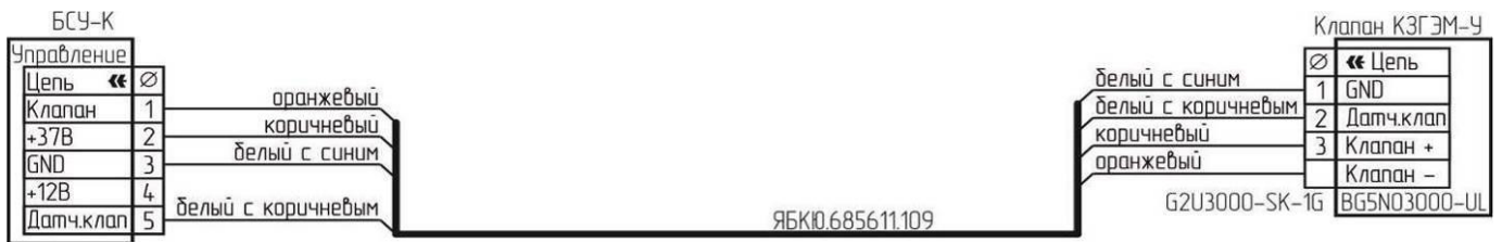
Рисунок Г.6 – Типовая схема подключения клапана КЗГЭМ-У с разъемом BG5N03000-UL
