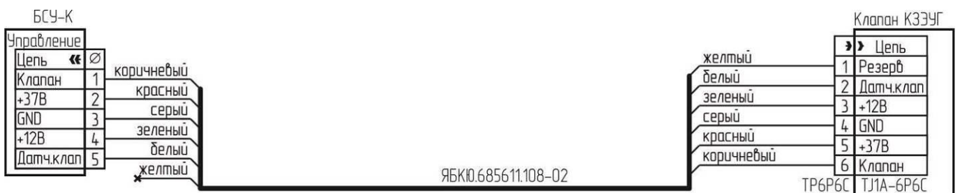
Рисунок Г.8 – Типовая схема подключения клапана КЗЭУГ с разъемом TJ1A-6P6C
