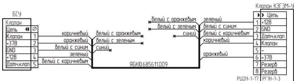
Рисунок Б.5 – Схема подключения клапана КЗГЭМ-У с разъемом РГ1Н-1-3.
