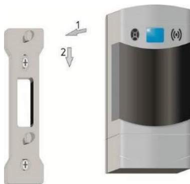
Рисунок Г.2 – Установка БСУ на монтажную панель
