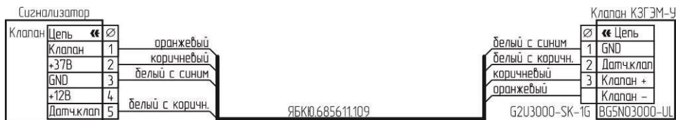
б) схема подключения КЗГЭМ-У с разъемом BG5NO3000-UL;
