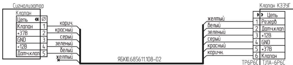
г) схема подключения КЗЭУГ с разъемом TJ1A-6P6C.
