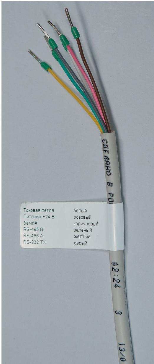
Рис.6. Цветовая маркировка кабеля
