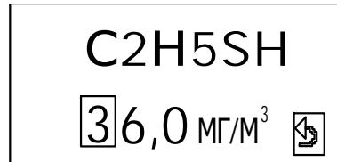
Рисунок 3.6 – Внешний вид меню корректировки чувствительности по C<sub>2</sub>H<sub>5</sub>SH
