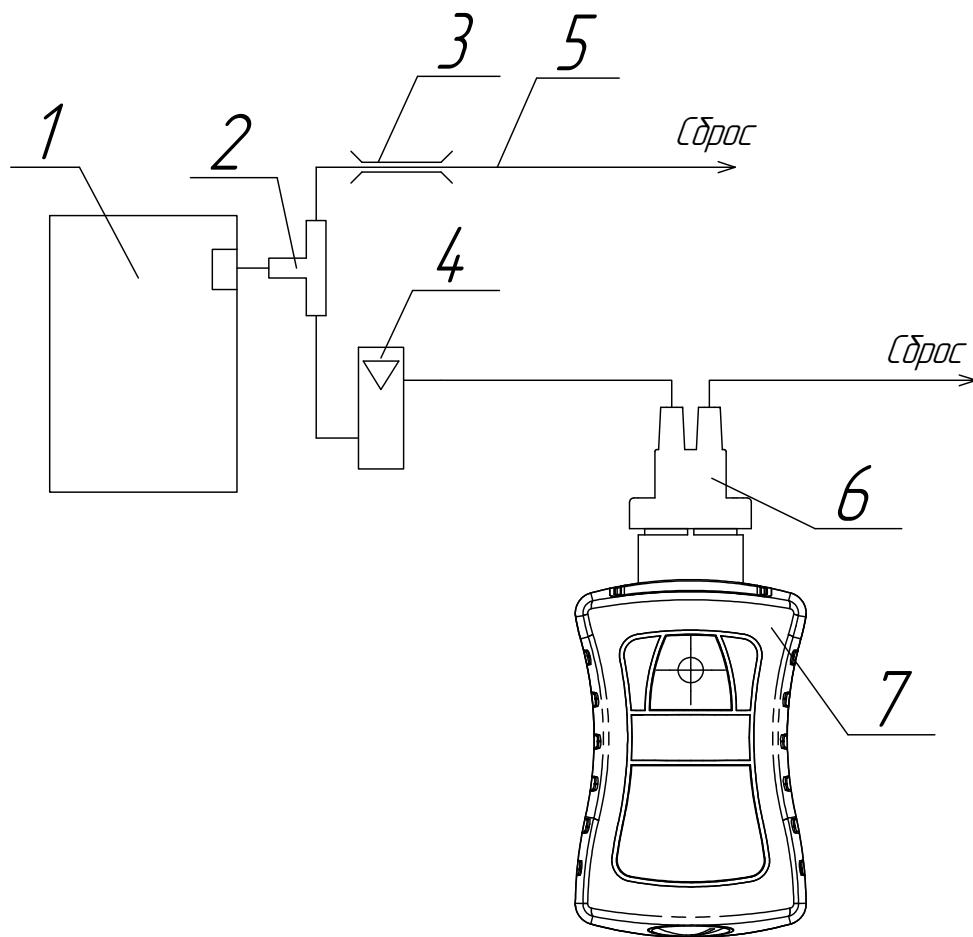
1 – генератор ГДП-102 с источником микропотока  $C_2H_5SH$ ;
