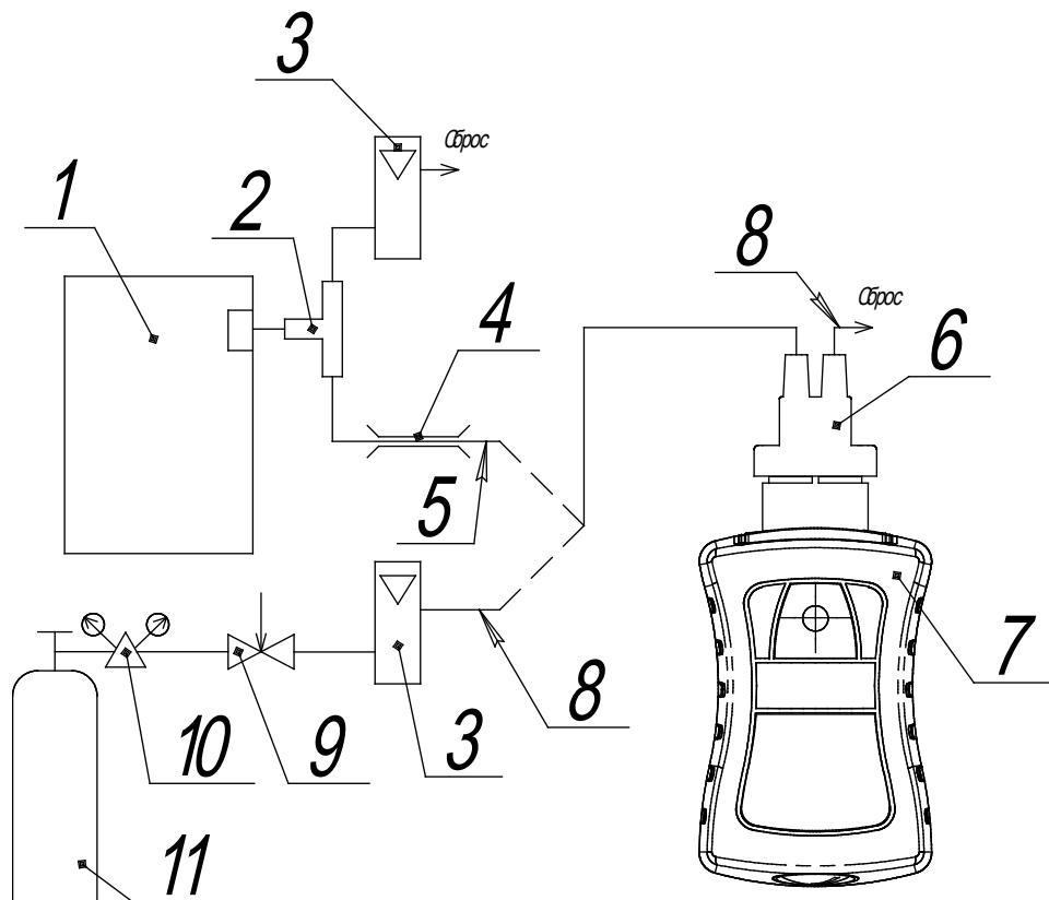
1 – генератор ГДП-102 с источниками микропотока  $\text{H}_2\text{S}$ ,  $\text{Cl}_2$ ,  $\text{SO}_2$ ,  $\text{NO}_2$ ,  $\text{HCl}$ ;
