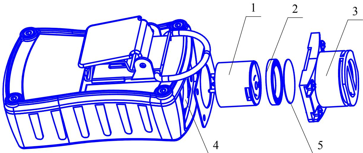
Рисунок 3.9 – Схема замены ФИД
