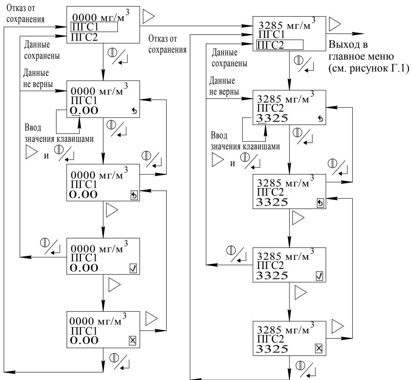
Рисунок Г.3 - Схема режимов работы.
