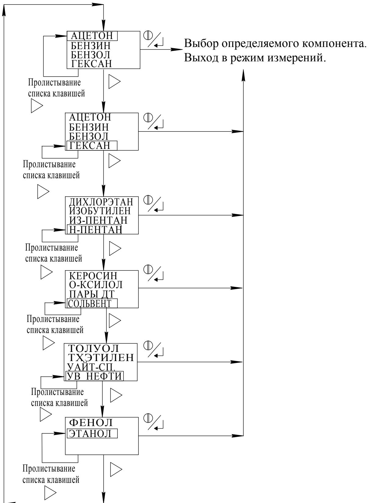
Рисунок Г.2 - Схема режимов работы.
