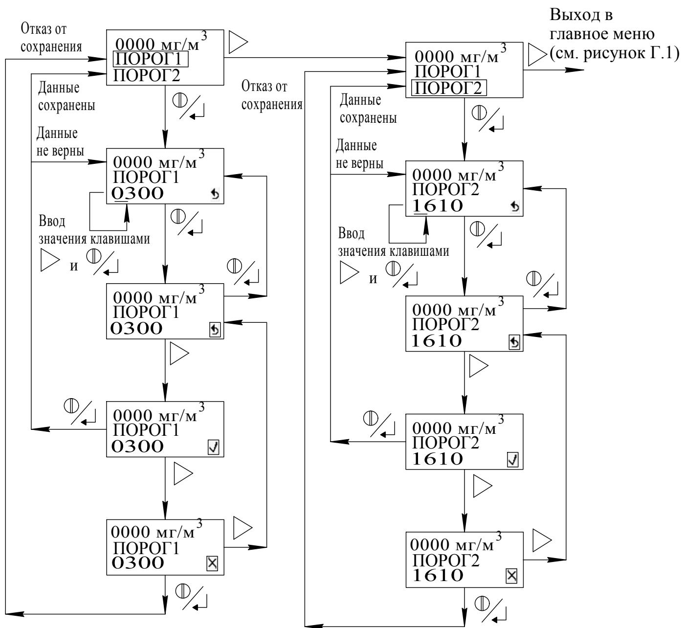
Рисунок Г.4 - Схема режимов работы. Режим установки пороговых значений
