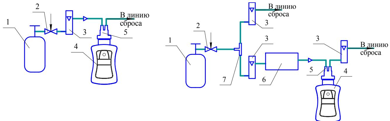
а) схема корректировки нулевых показаний и чувствительности газоанализаторов по газовым смесям, подаваемым от баллонов
