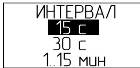
Рисунок 2.9 – Меню выбора интервала записи в архив газоанализатора
