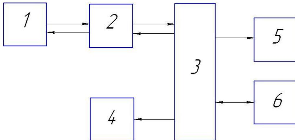
1 – сенсор; 2 – сенсорный модуль; 3 – процессорный модуль; 4 – световая и звуковая сигнализация; 5 – схема закрытия газозапорного клапана и/или включения внешних устройств; 6 – модуль интерфейса RS-485 (только у модификации с наличием интерфейса RS-485, см. таблицу 1)
