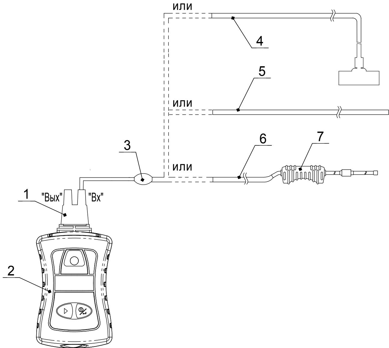
Рисунок 2.1 – Способы принудительной подачи пробы
